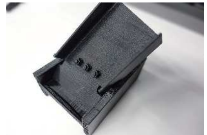
写真4 梁接手の3Dプリント
